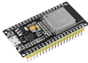
Figura 1. Microcontrolador ESP32 con comunicación Wifi.
